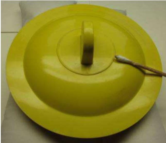
**Abbildung 23.** Oberflächenreinigung mit Watte-
