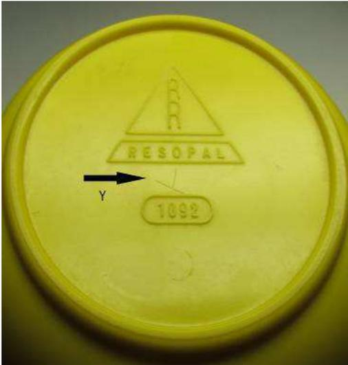
**Abbildung 14.** Eingeritzte Markierung am Boden der Kanne
