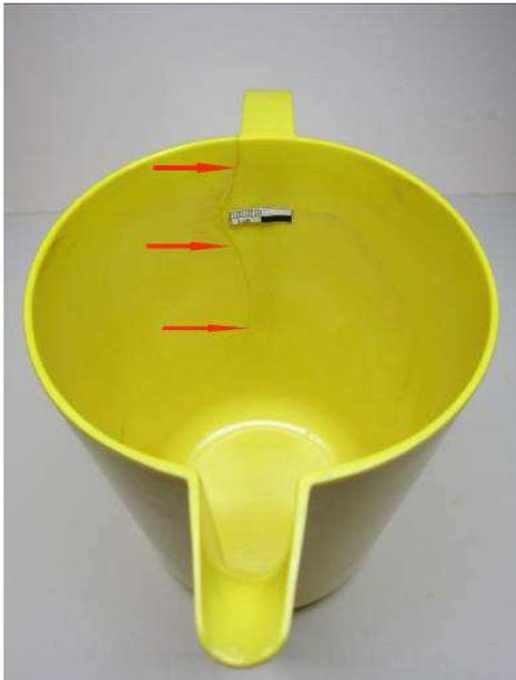
**Abbildung 31.** Nach der Klebung des Risses auf der Innenseite
